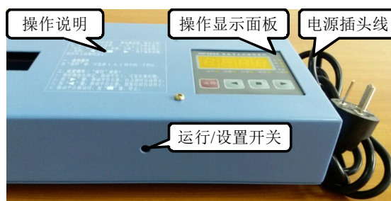
图 3 隐藏式“运行/设置”状态选择开关
